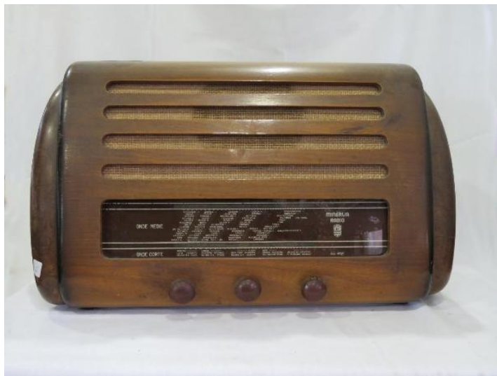
MINERVA Radio mod. 495/1 (1948) mobile in legno, circuito supereterodina, gamme d'onda OM-OC, scala parlante in vetro a indice scorrevole, altoparlante a magnete permanente circolare, alimentazione CA 220V con cambiatensione.
