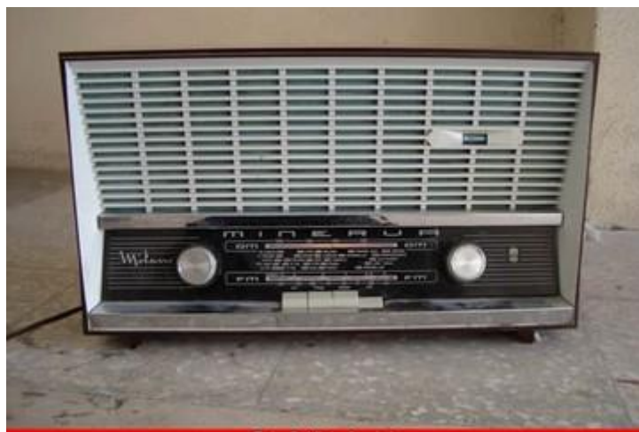
MINERVA Radio mod. 495/1 (1948) mobile in legno, circuito supereterodina, gamme d'onda OM-OC, scala parlante in vetro a indice scorrevole, altoparlante a magnete permanente circolare, alimentazione CA 220V con cambiatensione.
