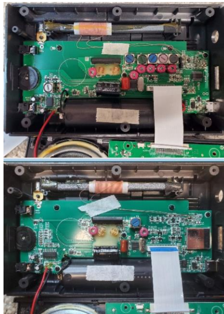
In alto, il PCB originale, in basso il nuovo PCB
