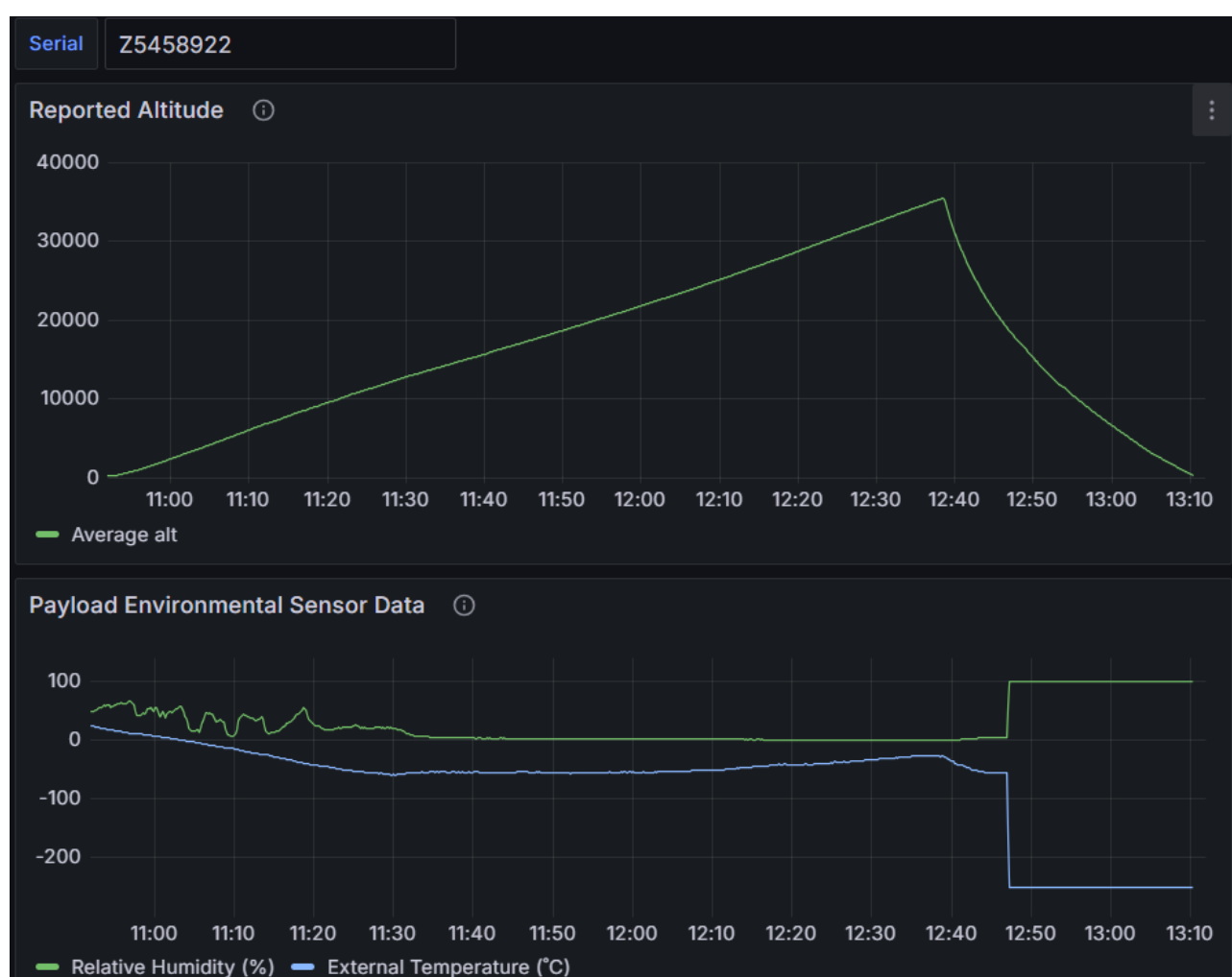
Figura 4: DATI RACCOLTI; quota istantanea, umidità relativa e temperatura esterna rispetto al tempo di volo (in orario Z);
