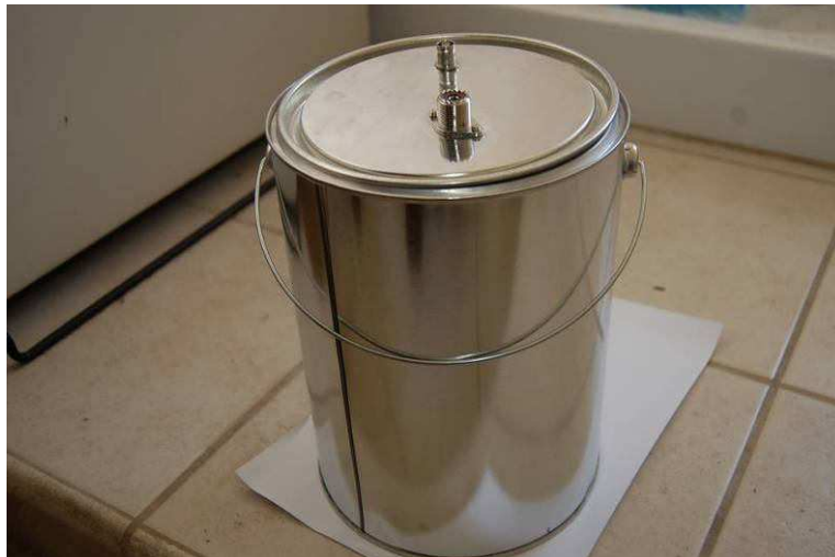
Figura 12 - Carico fittizio 50 ohm - 1.600W in olio di paraffina, realizzato da me
