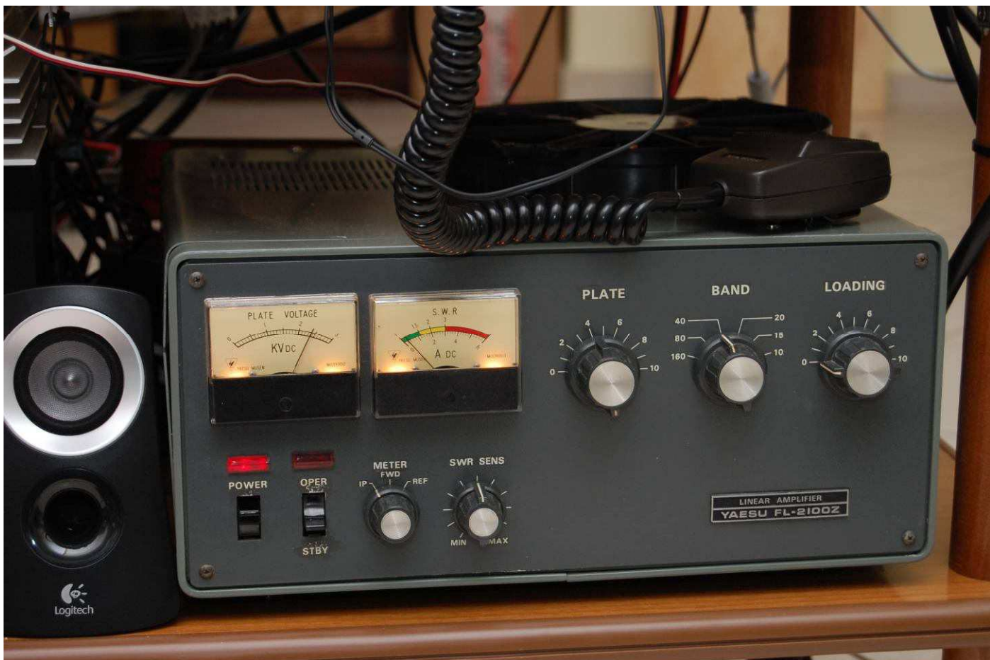
Figura 7 - Amplificatore lineare FL-2100Z con valvole 572B e alimentazione anodica a 2.400V
