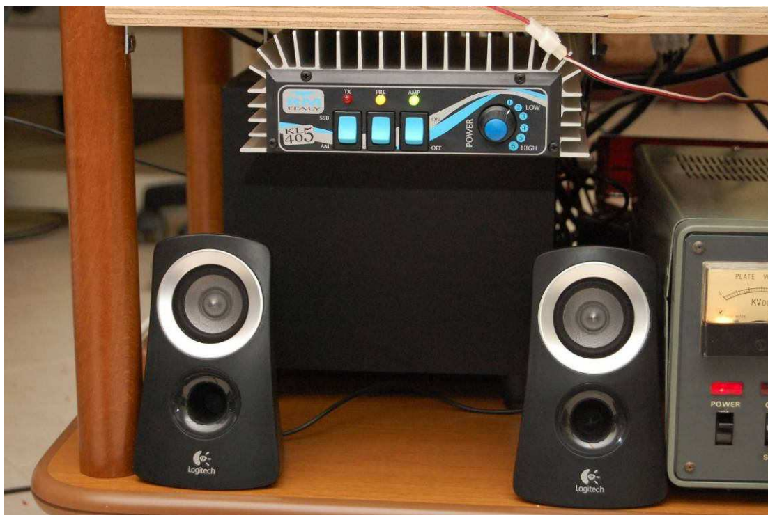
Figura 9 - Amplificatore lineare a transistor della RM, Casse amplificate da 25 W RMS della Logitech
