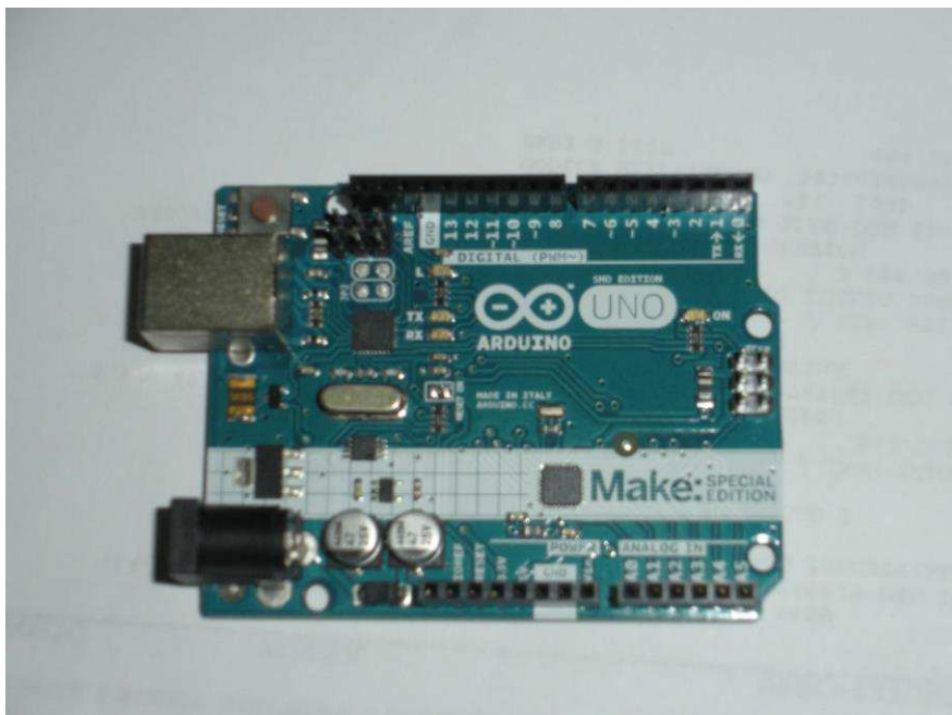
Figura 1: La scheda Arduino Uno Rev.3; foto De Vitis.
