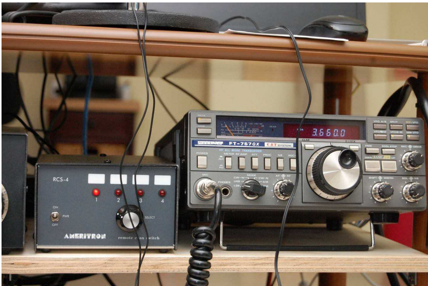
Figura 5 –Console di commutazione antenne sulla posizione 1, RTX Sommerkamp FT-757 GX
