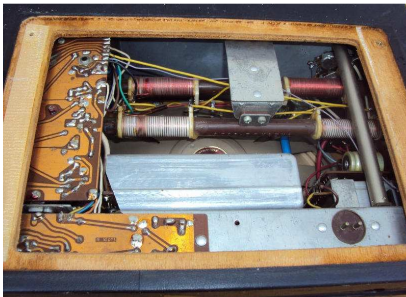
Antenne in ferrite per Onde medie e Lunghe interne
